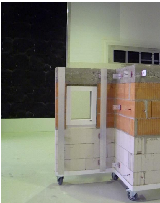
Abb_2: Im Vordergrund ein Schulungsmodell, an dem verschiedene Arbeitsschritte beim Erstellen einer VHF geübt werden können. Im Hintergrund die große VHF, an der die Ausrichtung der Unterkonstruktion in realistischem Maßstab trainiert wird.
